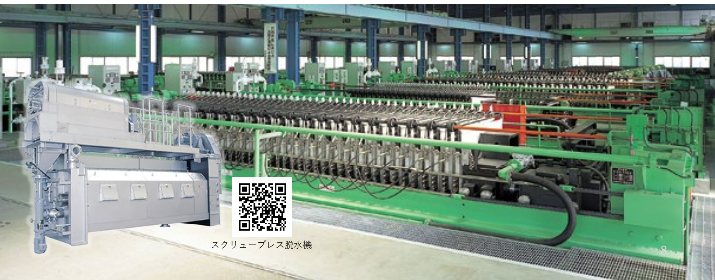
フィルタープレス脱水機
