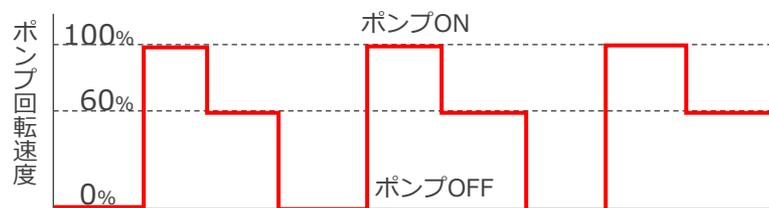
インバータによる回転速度制御
